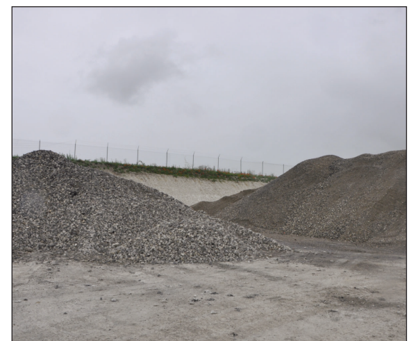
Nouveauté pour Gorez, les déchets de chantier arrivent sur site et sont triés puis concassés sur place pour faire leur propre matière première.
