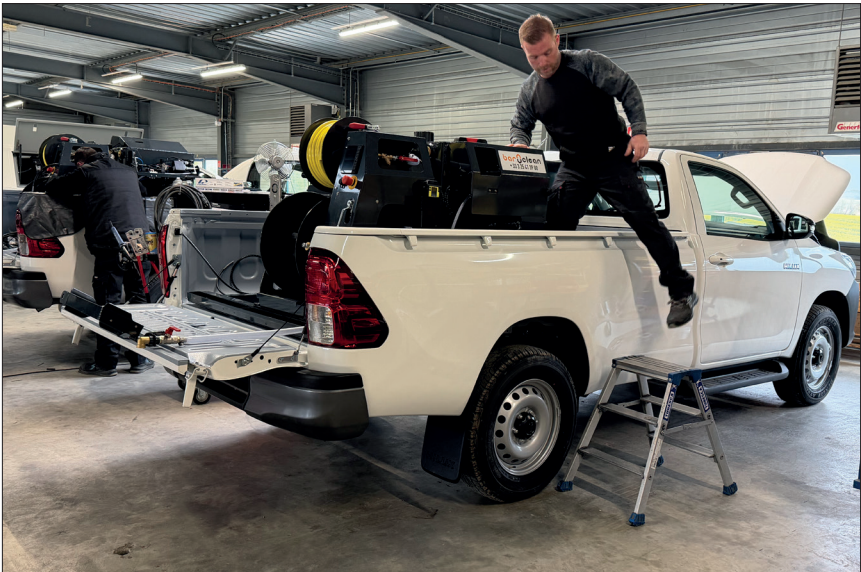
Assemblage d'un hydrocureur.
