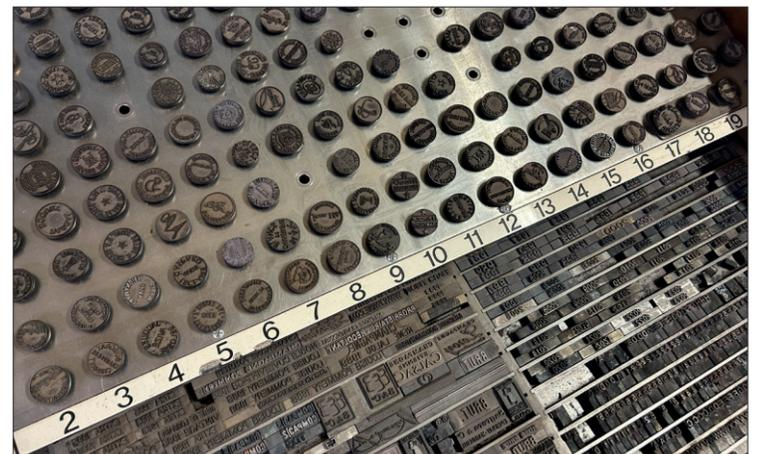
Le marquage à feu, plus traditionnel, est réalisé avec des matrices métalliques chauffées. Il permet de marquer 5 à 8 000 bouchons à l'heure.
