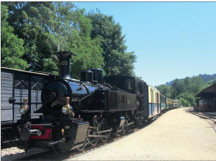
Comme beaucoup de vieilles dames, la Mallet 403 est aussi coquette que fragile. Elle apprécie donc particulièrement que l'on prenne le temps de s'occuper d'elle. Graissage des différentes pièces en mouvement, montée en température et en pression de la chaudière, etc. : près de 3 heures de préparation sont ainsi nécessaires avant qu'elle ne s'engage sur les rails.
