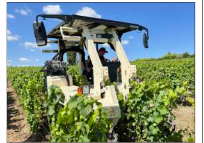
Les enjambeurs et chenillards 100% électriques SabiAgri (Ravillon) proposent 10h d'autonomie.
