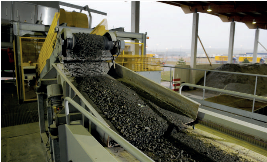
Les propriétés de "l'Ecograde" obtenue après tri, maturation et criblage des mâchefers, sont reconnues comme équivalentes à celles des matériaux naturels extraites des carrières pour une utilisation en remblais ou en couche de fondation de voiries.
