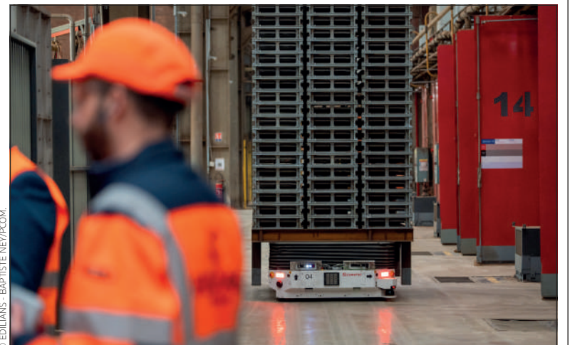
L'acquisition de véhicules autonomes (AGV) permet de transporter jusqu'à 3,5 tonnes de palettes de tuiles tout au long du process.
