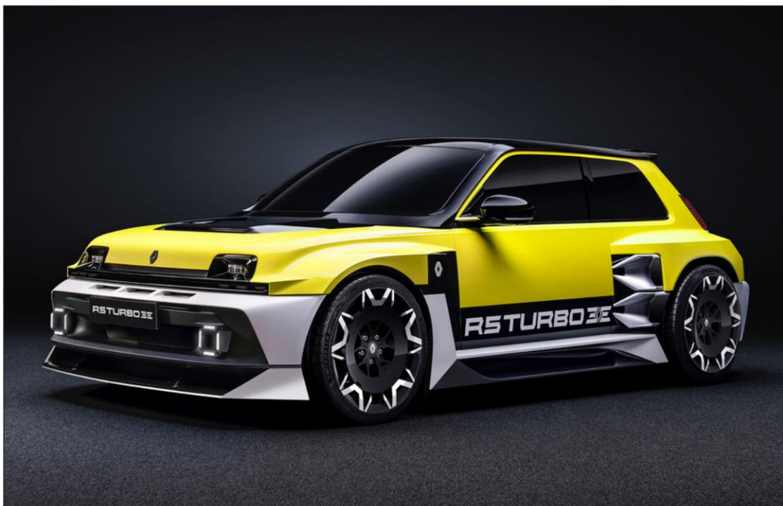
Un moteur électrique sur chaque roue arrière pour un total de 500ch.
